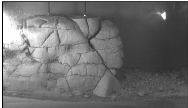
Fig. 2. Bloc de craie «sous miné» avant la rupture complète de l'échantillon (d'après STONE et al. [10])
